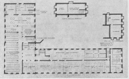
Fig. 2. — Plan du rez-de-chaussée inférieur. — 1:600.
