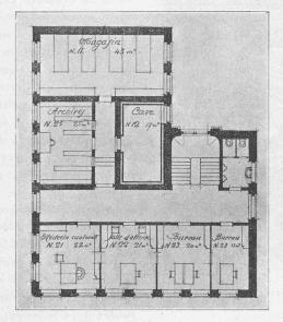
Fig. 19. — Plan du rez-de-chaussée inférieur. — 1:300.
