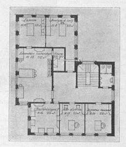
Fig. 21. — Plan du 1er étage. — 1:300.
