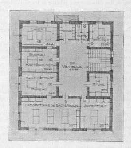
Fig. 17. — Plan du 1er étage. — 1:300.
