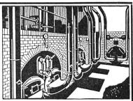
installation de soufflerie sous grille «Fæhn» pour combustibles pauvre
