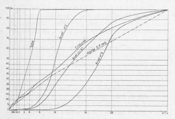
Fig. 2. — Composition granulométrique des concassés des carrières d'Arvel.
