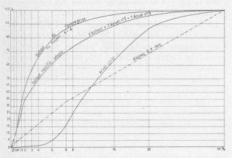
Fig. 3. — Composition granulométrique de mélanges de graviers rectifiés.
