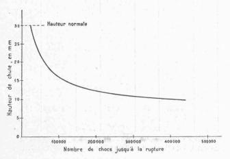
Fig. 12. — Influence de la hauteur de chute du mouton sur le nombre des chocs nécessaires pour obtenir la rupture.
