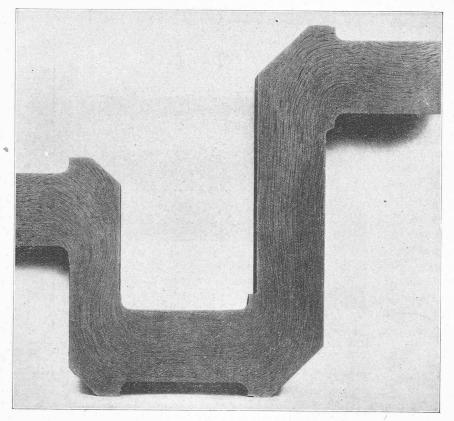
Fig. 4. — Aspect des fibres d'un vilebrequin correctement matricé.
