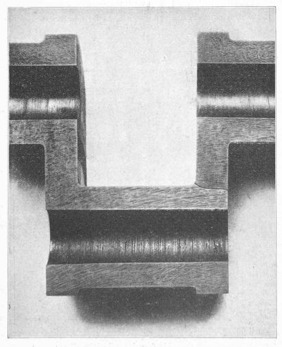
Fig. 3. — Section du vilbrequin de la fig. 2 montrant la direction des fibres de l'acier et la cassure. — Ebauche défectueuse.
