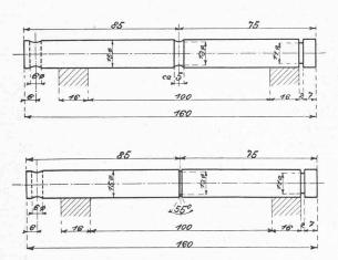
[Fig. 7 et 8. — Eprouvettes normales avec entaille à fond arrondi (fig. 7) et aigu (fig. 8).
