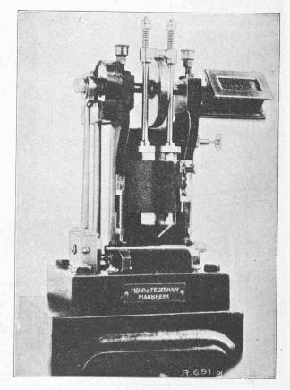
Fig. 6. — Appareil système Krupp pour l'étude de la flexion par chocs répétés sur barreaux entaillés.
