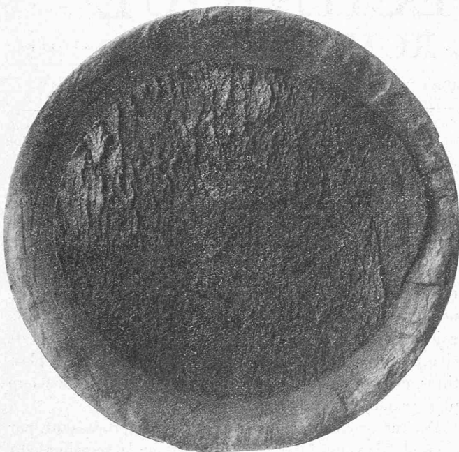
Fig. 1. — Cassure d'un essieu de wagon, en acier Thomas.
