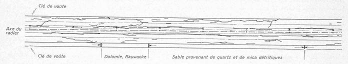
Fig. 7. — Relevé des fissures entre les hectomètres 7,2 et 7,9, après le sixième remplissage. — 1:400.
