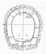
Type III et Type IIIa, armé; anneau de béton armé de 0,31 m², 38 kg. d'acier par m. de longueur. d = distance des fers.
