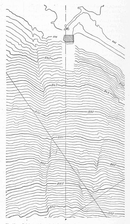
Fig. 15. — Partie supérieure de la fig. 14 dont les courbes ont été désenchevêtrées en les décalant chacune de 2 mm. par une translation parallèle à la droite 4-P, afin de pouvoir tracer les profils de la partie surplombante. Voir la description de cet artifice dans notre dernier numéro.
