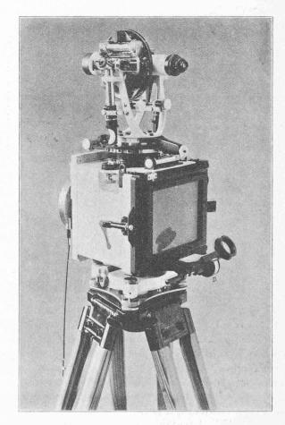
Fig. 12. — Photothéodolite Zeiss.
