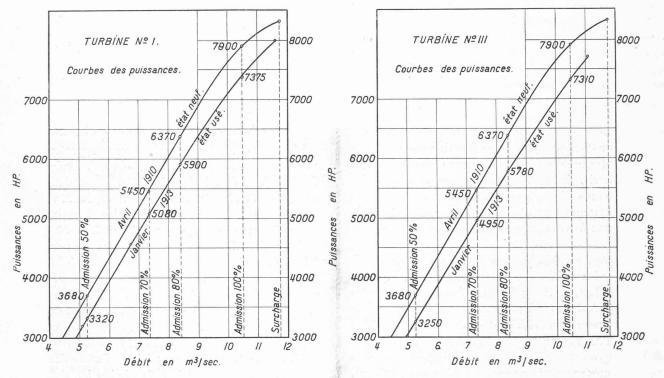
Fig. 8. — Diagrammes des puissances des turbines de l'usine de « Molinar » à l'état neuf et après 21 mois de service.
