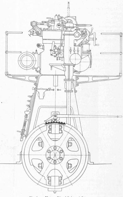
Fig. 4. — Moteur Diesel-Sulzer, à 2 temps.
