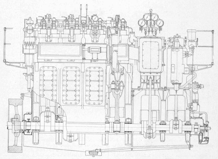
Fig. 3. — Moteur Diesel-Sulzer, à 2 temps.
