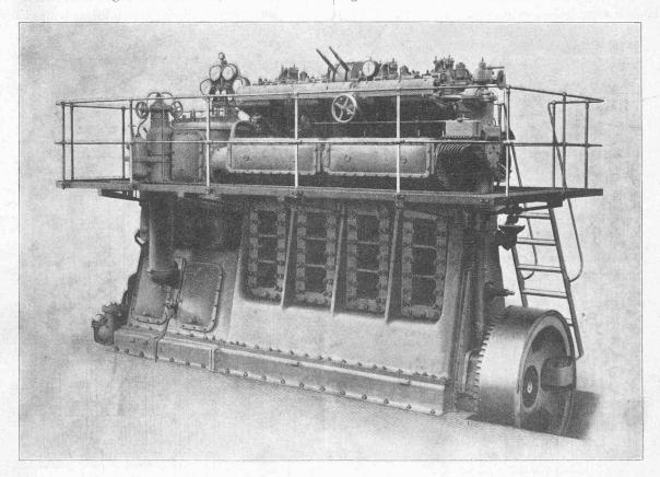
Fig. 1. — Moteur Diesel-Sulzer, à 2 temps.
