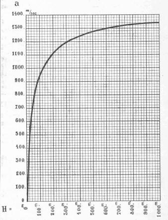
Fig. 22. — Valeurs de la vitesse de propagation a en fonction de H dans une conduite calculée avec  $\sigma = 6 \text{ kg/mm}^2$ .
