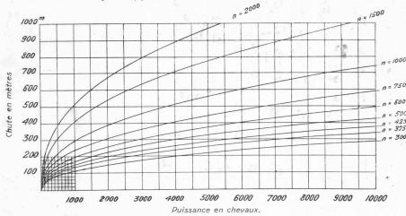
Fig. 20. — Turbine Pelton à 1 jet. —  $n_s = 26$  (max.).
