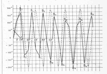
Fig. 4. — Conduites en deux tronçons. Coup de bélier au vannage pour fermeture complète cd en  $\frac{4l'}{a'} = 2{,}18$  sec.
