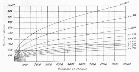
Fig. 21. — Turbine Pelton à 2 jets. —  $n_s = 36$  (max.).
