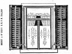
Pour manœuvrer les volets à fenêtres fermées.
