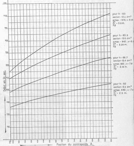
Fig. 3. — Débit de l'appareil en fonction de la position du contrepoids.
