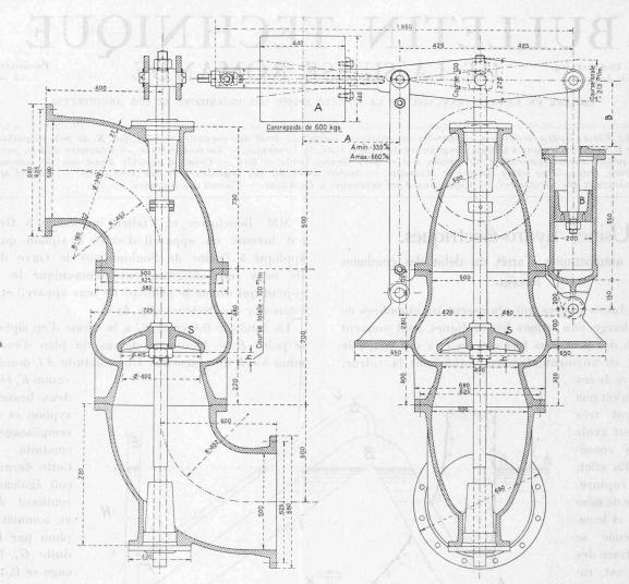
Fig. 2. — Vanne-clapet automatique de l'usine de Fully. — 1:20.
