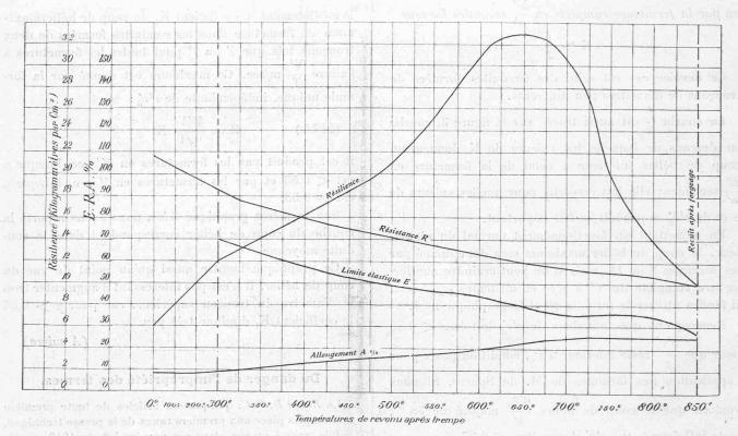
Variation des propriétés mécaniques d'un acier mi-doux, qualité « marine », des Aciéries et Forges de Firminy, en fonction de la température de revenu, après trempe à l'eau à 850°.
