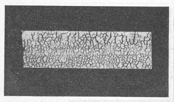
Fig. 3. — Barreau de choc prélevé dans un rail.
