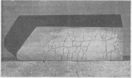
Fig. 1. — Acier rapide trempé, meulé puis attaqué à l'acide sulfurique. Grossissement = 2.
