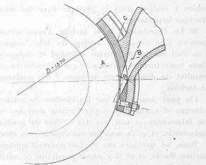
Fig. 17. — Distributeur. — Coupe longitudinale.
