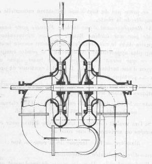
Fig. 19.  $N_s=44$  par roue.  $N_s=31$  pour l'ensemble.
