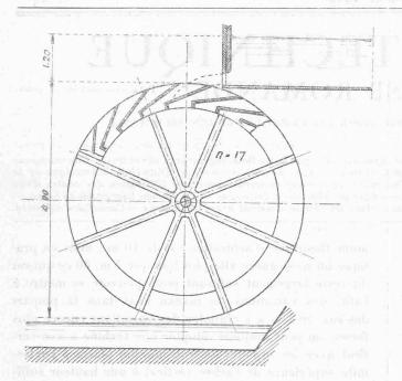
Fig. 12. — Distributeur. — Coupe longitudinale.
