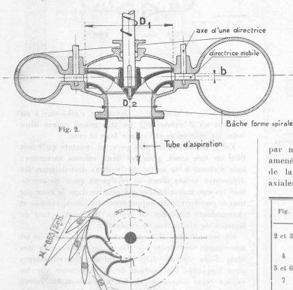
Fig. 3. — Coupe horizontale.  $N_s \text{ min.} = 50.$
