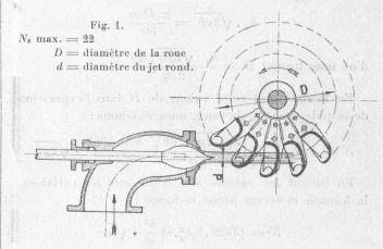
=D et un jet rond de diamètre d. Dans l'état actuel de la construction des turbines la pratique a montré que le maximum de diamètre de jet que l'on peut admettre est égal au  $\frac{1}{10}$  du diamètre de la roue. Si l'on dépasse cette proportion, le rendement de la turbine diminue. Il n'est pas impossible que l'on arrive dans la suite à trouver une forme d'aubes qui permette d'aller plus loin avec cette proportion  $\frac{d}{D}$ .
