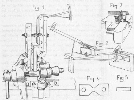
Fig. 1. Machine à essayer le métal à la traction. — Fig. 2 et 3. Marteau à ressort pour essayer le métal au choc. — Fig. 4. Eprouvette de traction. — Fig. 5. Eprouvette de choc.
