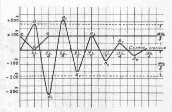
Fig. 19. — Fermeture c,d de  $v_0=1^{\rm m}50$  à  $v_1=0^{\rm m}$  en  $\frac{2{\rm L}}{a}$  soit 2 sec., immédiatement suivie d'une ouverture d,e de  $v_1=0^{\rm m}$  à  $v_2=1^{\rm m}50$  en  $\frac{2{\rm L}}{a}$  soit 2 sec.
