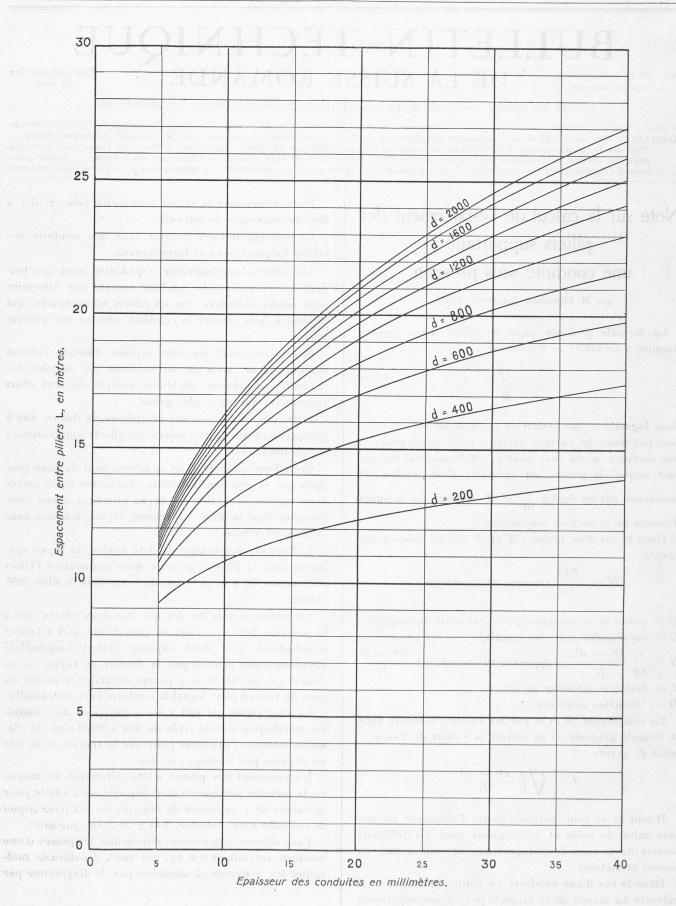
Diagramme donnant l'espacement admissible des piliers supportant une conduite sous pression calculée pour un travail maximum en pleine tôle de 6 kg. par mm².
