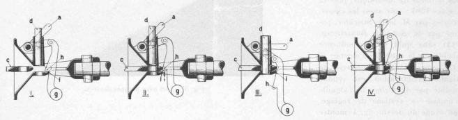
Fig. 4. — I à III Démonstration schématique de la manœuvre d'accouplement; IV découplement.
