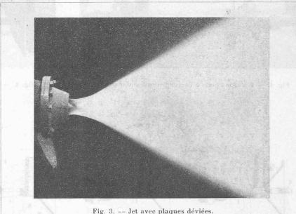
Fig. 3. -- Jet avec plaques déviées.
