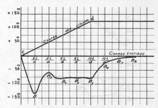
Fig. 17. — Ouverture cd de  $c_0=0$  à  $V_f=7^{\rm m},50$  en 10 sec.  $\frac{av_0}{2g\gamma_0}>1$  (Basses chutes).
