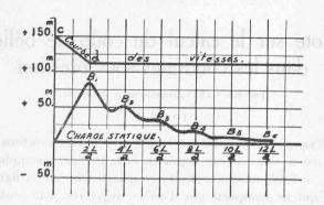
Fig. 43. — Fermeture partielle cd de  $v=6^{\rm m}$  à  ${\rm V}_f=4^{\rm m},50,$  en  $\frac{2{\rm L}}{a}$  sec. —  $\frac{a{\rm V}_f}{2gy_0}>1$  (Basses chutes).
