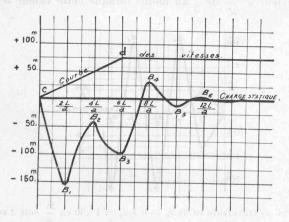
Fig. 15. — Ouverture cd de  $c_0=0$  à  $V_f=4^{\rm m},50$  en 6 sec.  $\frac{aV_f}{2g\gamma_0}<1 \quad \text{(Hautes chutes)}.$
