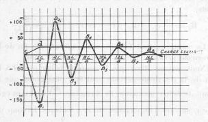
Fig. 14. — Ouverture de cd de  $c_0 = 0^{\rm m}$  à  $V_f = 4^{\rm m},50$  en  $\frac{2{\rm L}}{a}$  sec. avec arrêt de la vanne à la fin de la première période.
