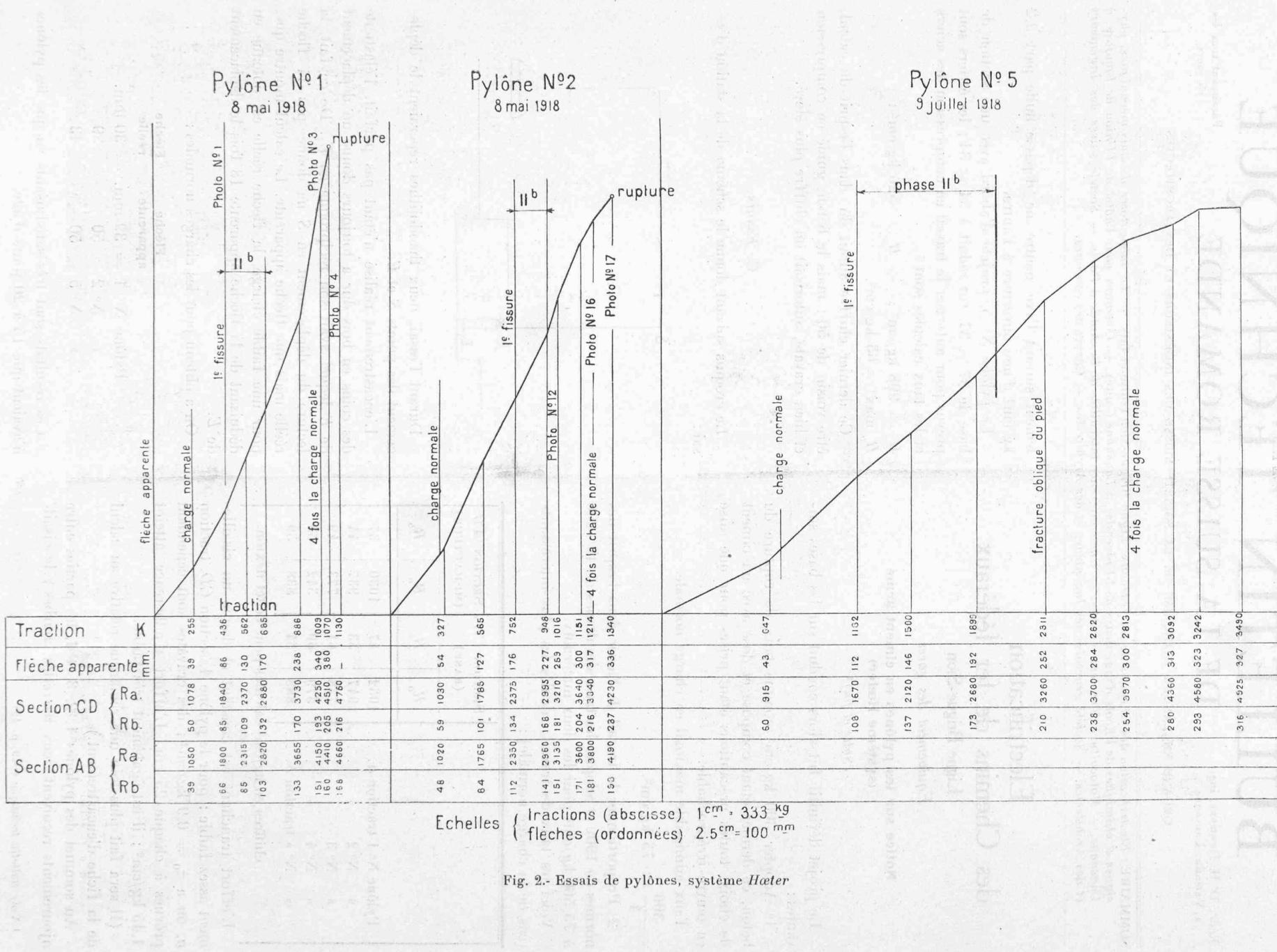
Fig. 2.- Essais de pylônes, système *Hæter*
