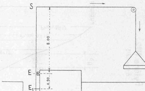
Durant l'essai, deux théodolites repéraient le déplacement des points S et E.
