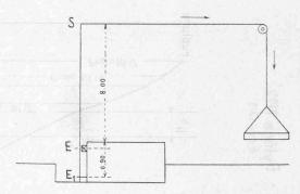
Durant l'essai, deux théodolithes repéraient le déplacement des points S et E.
