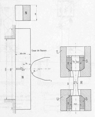
Fig. 25. - Eprouvette normale Charpy pour l'essai de traction
