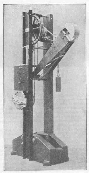
Fig. 26. - Mouton-pendule, système Amsler.
