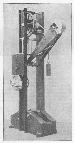
Fig. 26. - Mouton-pendule, système Amsler.
