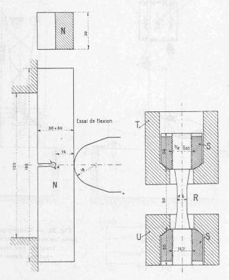
Fig. 25. - Eprouvette normale Charpy pour l'essai de traction de flexion par choc. par choc.
