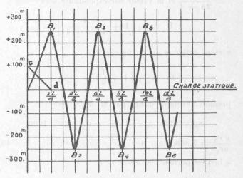
Fig. 5. — Fermeture complète cd de  $v_0=2^{\rm m}$  à  $0^{\rm m}$  en  $\frac{2\rm L}{a}$  sec.
