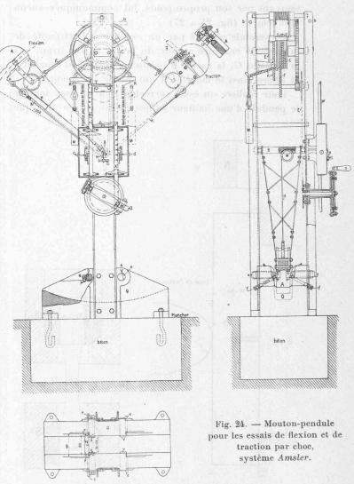
varie, de l'un à l'autre, dans le rapport de 60 à 11, variation qui dénote une grande différence de fragilité entre les deux échantillons et qui eût passé inaperçue si on se fût borné à l'essai de traction. L'appareil que nous allons décrire est du type *Charpy*: le choc est produit par la chute d'une masse animée d'un mouvement pendulaire d'amplitude réglable.
