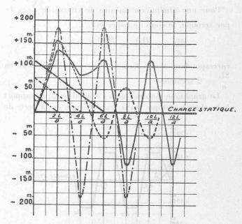
Fig. 8. — Fermeture complète T  $> \frac{2L}{a}$ ;  $\frac{av_0}{2gy_0} < 1$  (Hautes chutes) de V =  $4^m$ ,50 à 0 en 6" — de V =  $3^m$ ,00 à 0 en 4" ——— de V =  $4^m$ ,50 à 0 en 2" ————
