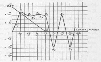
Fig. 7. — Fermeture complète cd de  $v_0=6^{\rm m}$  à  $0^{\rm m}$  en 8 sec. T  $> \frac{2{\rm L}}{a}$ ;  $\frac{av_0}{2g\gamma_0} < 4$  (Hautes chutes).
