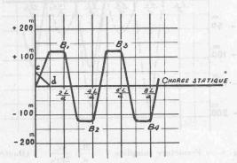
Fig. 6. — Fermeture complète cd de  $V=1^{m}$  à  $0^{m}$  en  $\frac{L}{a}$  sec.
