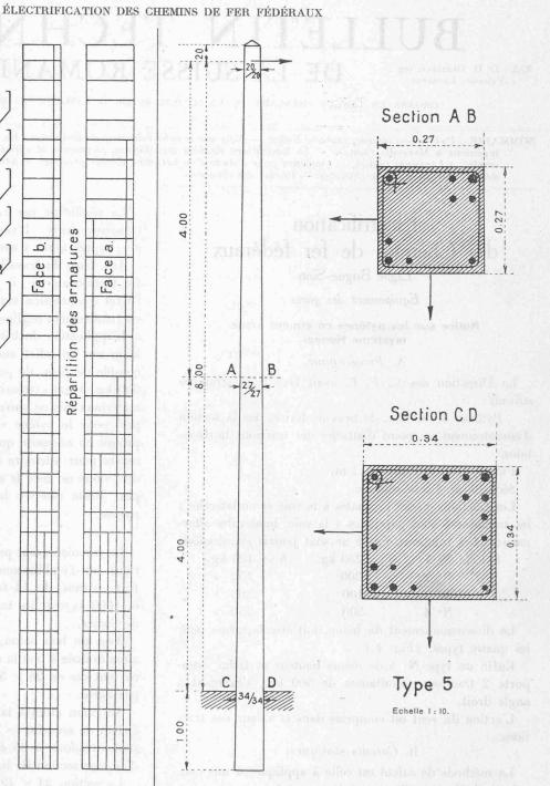
Type 5 Fig. 1. — Pylônes système Hæter.
