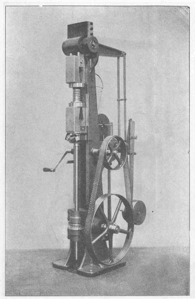
Fig. 22. — Essai à la compression d'un ressort.
