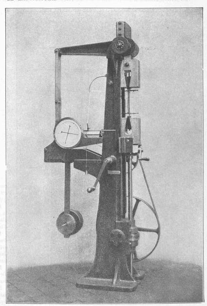
Fig. 21. — Essai d'un fil à la traction.
