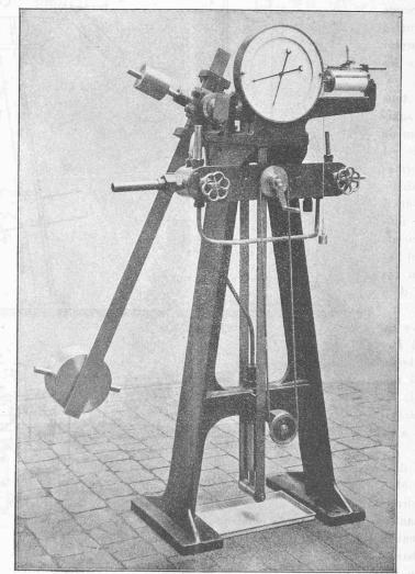
Fig. 14. — Dynamomètre avec robinets distributeurs et commande à main du piston réducteur. (Vue de face.)
