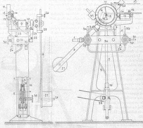
Fig. 43. — Dynamomètre à pendule, système Amsler.
