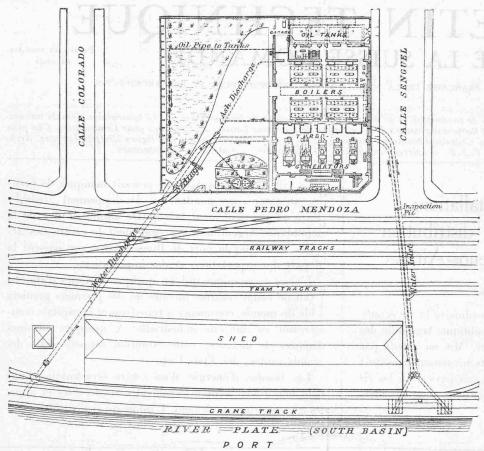
Fig. 2. - Plan d'ensemble de la centrale à vapeur.
