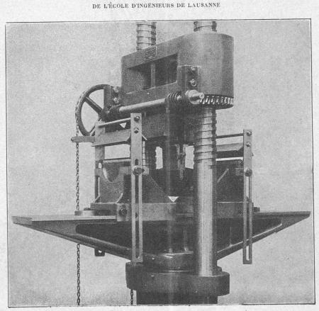
Fig. 12. - Essai de pliage.
