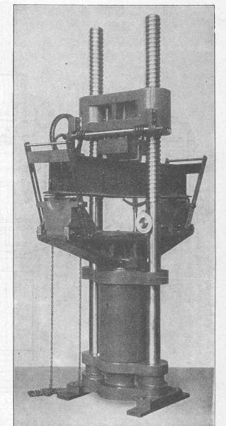
Fig. 11. — Essai à la flexion.
