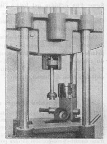
Fig. 5. Amarrage des barreaux cylindriques à épaulements.
