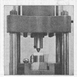
Fig. 8. Essai de dureté à la bille.
