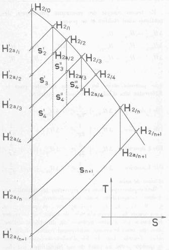
Fig. 2. — Diagramme entropie (S), température (T) relatif à la détente de la vapeur dans un ailettage Parsons (schéma).
