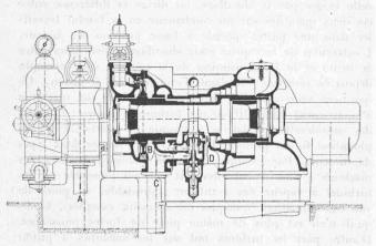
Fig. 1. — Coupe à travers une turbine à prise de vapeur Brown Boveri-Parsons.
