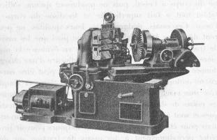
Fig. 5. - Machine automatique à tailler les engrenages coniques. Modèle nº 2. admettant des engrenages jusqu'à 500 mm. de diamètre primitif.
