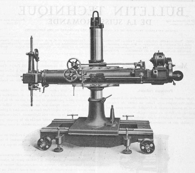
Fig. 4. -- Machine à percer radiale universelle montée sur chariot et perçant dans le plein jusqu'à 50 mm. de diamètre.
