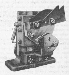
Fig. 6. - Porte-gabarit bréveté de la machine à tailler les engrenages.
