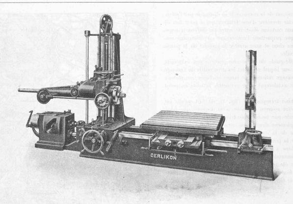
Fig. 2. — Machine horizontale à percer, aléser et fraiser, à bâti fixe et table à mouvement en croix avec broche de 80 mm. de diamètre.
