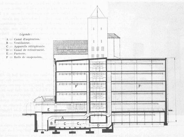
Fig. 20. — Schéma de l'installation frigorifique de la Maison Bell S. A., à Bâle.
