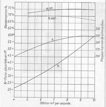
Fig. 12. — Caractéristiques d'un ventilateur centrifuge Suerlz à moyenne prèssion, de 750 mm. de diamètre de roue à ailettes et tournant à 1250 tours/min.
