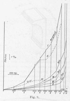
La surcharge portée jusqu'à 6384 kg. provoqua la lente dislocation des éprouvettes. La mesuration des flèches ne fut plus possible à partir de 6000 kg.
