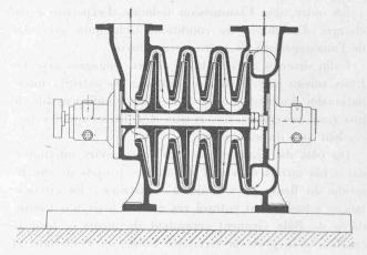
Fig. 41. — Coupe d'un ventilateur centrifuge Sulzer multicellulaire à haute pression.
