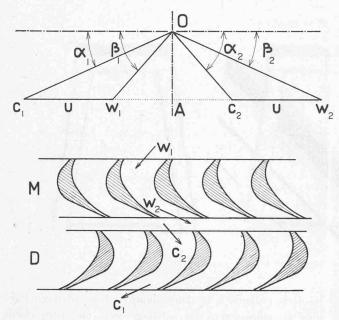
Fig. 1. — Diagramme des vitesses et profils d'aubes pour un élément d'ailettage Parsons.
