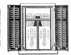
Pour manœuvrer les volets à fenêtres fermées.
