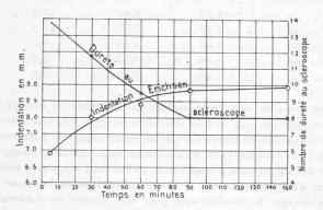
Fig. 9. — Courbes d'indentation et de durété pour des recuits à température constante de 200° et de durée variable.
