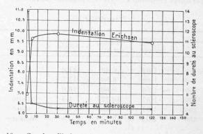
Fig. 10. — Courbes d'indentation et de dureté pour des réchauffages à température constante (400°) et de durée variable.
