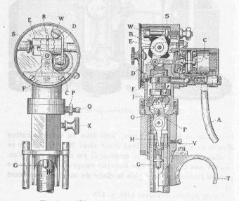
Fig. 5. — Mécanisme du scléroscope de Shore.
