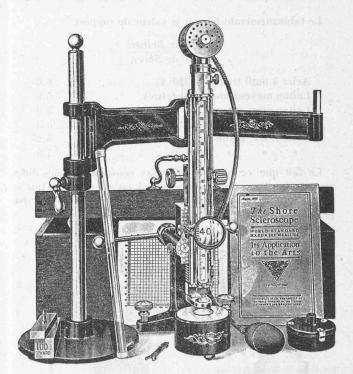
Fig. 4. — Le scléroscope de Shore.
