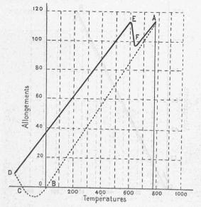
Fig. 4. — Courbe de dilatation d'un acier à  $33\,^{\circ}/_{0}$  de nickel refroidi dans l'air liquide.
