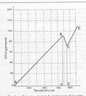
Fig. 2. — Principe général du traitement d'un acier.  $\alpha = \text{Température maximum de revenu.}$   $\beta = \text{Température minimum de chausse pour la trempe.}$
