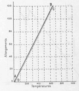
Fig. 3. — Courbe de dilatation d'un acier à 33 º/o de nickel.
